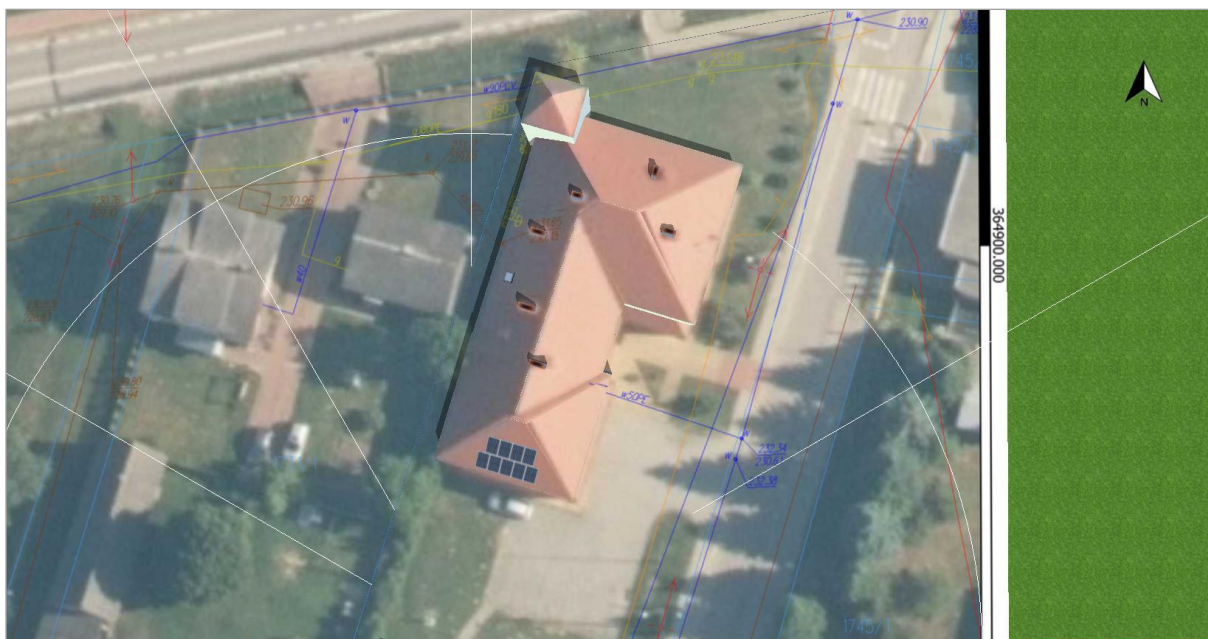
Rysunek 3.3 Proponowane rozmieszczenie modułów
